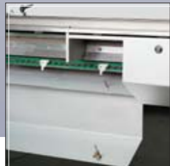
Cinta de alimentación con puertas abatibles Infeed conveyor with side hinged panels Convoyeur d'alimentation avec des portes abatibles
