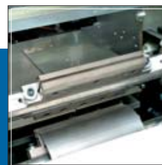
Grupo de soldadura y corte transversal RT RT Transversal sealing and cutting unit Groupe de soudure et coupe transversale RT
